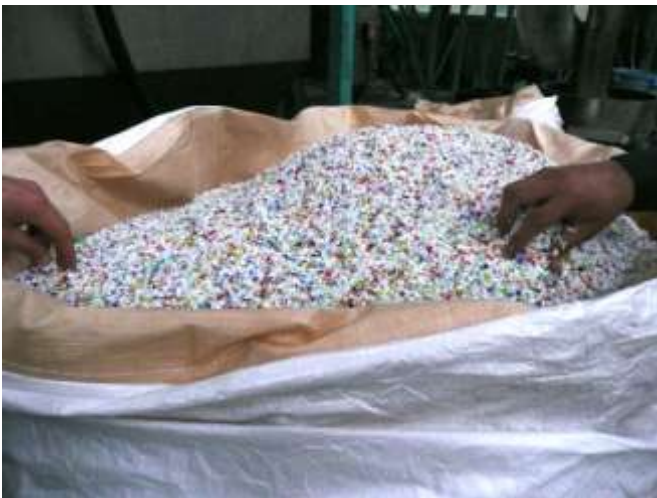
洗浄・沈殿の工程で水に浮いたキャップ部分
